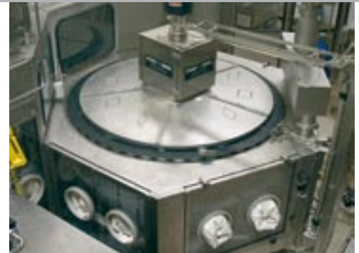
Aseptische Ausführung des Procomac Fillstar FX mit mikrobiologischem Isolator.
